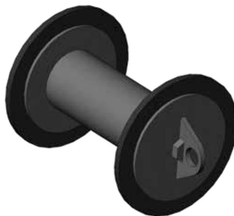
Серия MD с размерами 14" и меньше состоит из цилиндрической конструкции со сквозным болтом и сцепным крюком. Уплотняющие диски, изнашивающиеся при проходе в одном направлении, можно использовать в другом направлении без вреда их уплотняющим свойствам. Все диски изготовлены из специального смешения износостойчивого материала Apache Reliathane.
